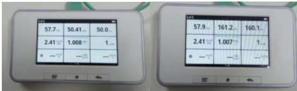
Gambar 4.6 Hasil Pengujian Dosis Radiasi pada monitor Base Unit Ray Safe X2 dengan 32 mA.
