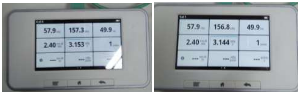
Gambar 4.7 Hasil Pengujian Dosis Radiasi pada monitor Base Unit Ray Safe X2 dengan 100 mA.
